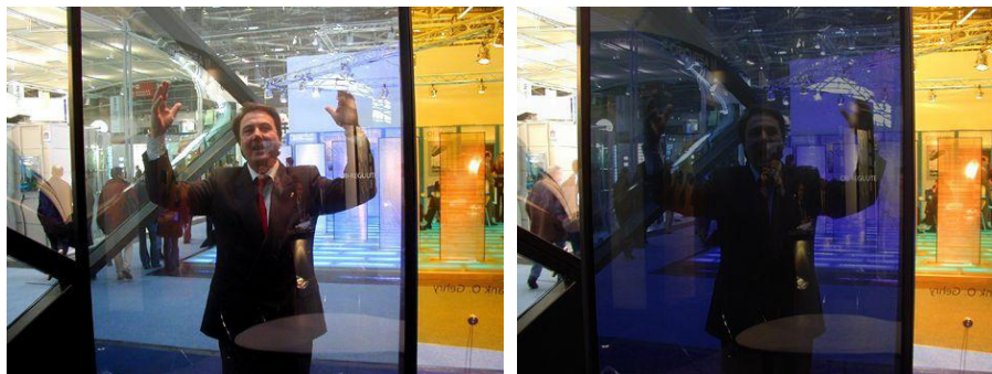
Sl. 21. Gasohromatsko staklo, (www.gpd.fi, W. Haase, ILEK)
