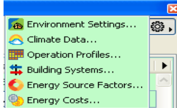
slika 8. U datom prozoru prikazani su parametri, čiji podaci se unose za dati model objekta, Environment Settings: unose se podaci vezani za lokaciju objekta, klimatski uslovi, uticaji vetra i osenčenost od okolnjeg drveća, Climate Data: klimatski uslovi za datu lokaciju na kome se objekat nalazi se download-uje, Operation profile: izbor namene objekta, Building Systems: unose se podaci za grejanje, hlađenje, sanitarnu toplu vodu, ventilaciju i o sistemima za grejanje na obnovljive izvor energije, Energy Source Factors: podaci o korišćenim energentima i Energy Costs: podaci o ceni energenata
