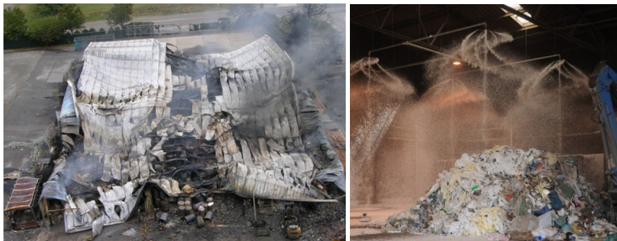
Slika 7 Požar i više manjih eksplozija jednog skladišta opasnog otpada u USA; proba instalacije za gašenje vrednijih i toksičnih otpadnih materijala sredstvom One-seven(papir i plastika su privremeno tu)
