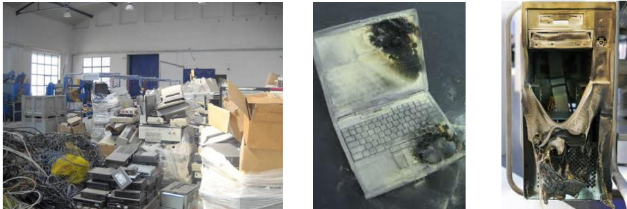
Slika 2 Nabacani elektronski otpad u suštini više plastika (ABS) ali ima i značajnih količina smola, teških metala; u požaru nastaju opasne pare (toksični produkti)
