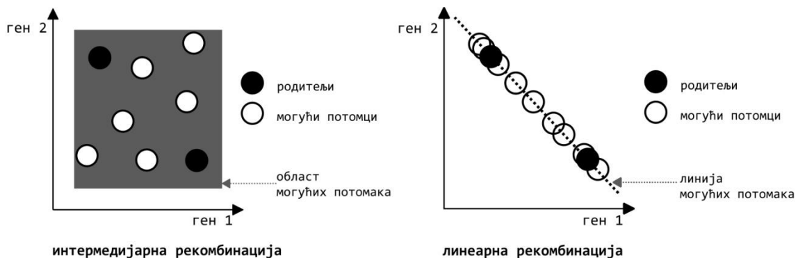
Слика 2.2.7 Графички приказ принципа интермедијарне и линеарне рекомбинације
