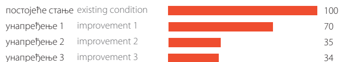
Графикон 5.13. Смањење емисије угљен- диоксида кроз унапређења у односу на постојеће стање (грејање, припрема СТВ и осветљење) [%]
