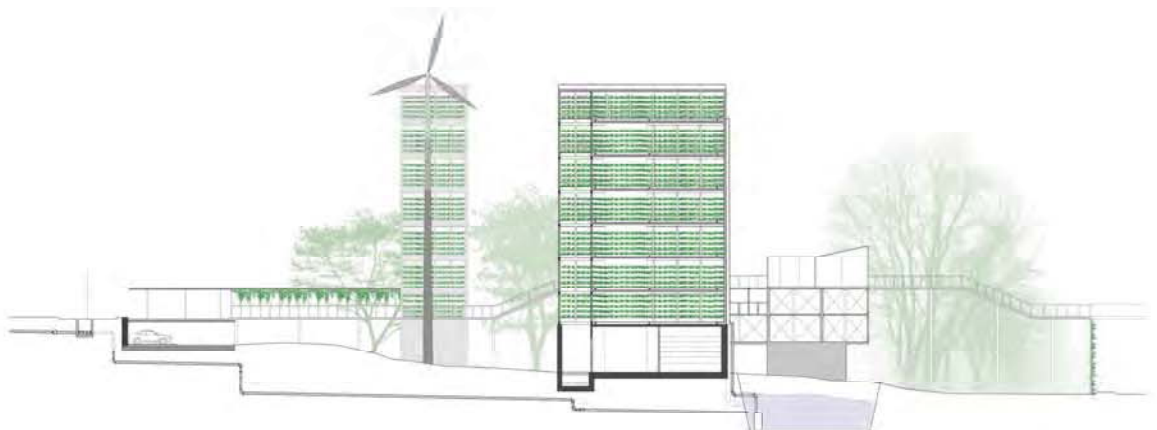
Попречни пресек - пресек кроз паркинг - пресек кроз вертикалну башту - пресек кроз систем за довођење атмосферских вода у базене за кишницу
