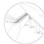
detalji spoja primarnih čeličnih nosača sa sekundarnim
