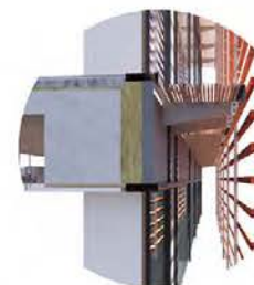
Детаљ потконструкције фасаде
