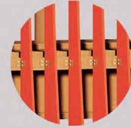
детали качења дупле фасаде
