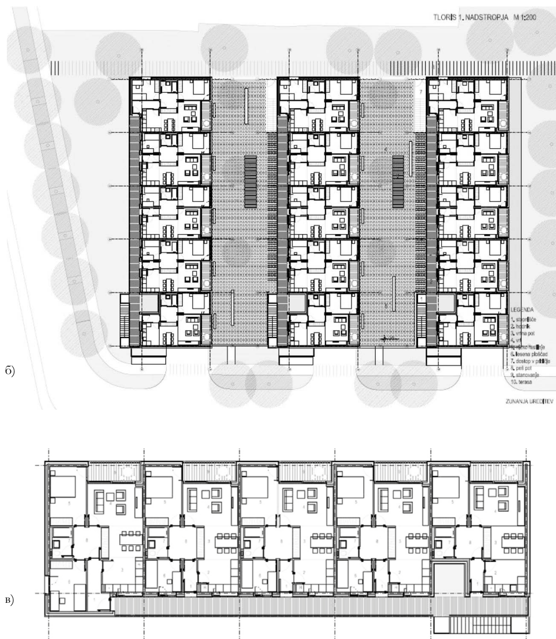
Слика 38: Дути мост, Љубљана, идејни пројекат, (а) изглед три ламеле са улице, (б) основа првог спрата три ламеле, (в) основа типске етаже
