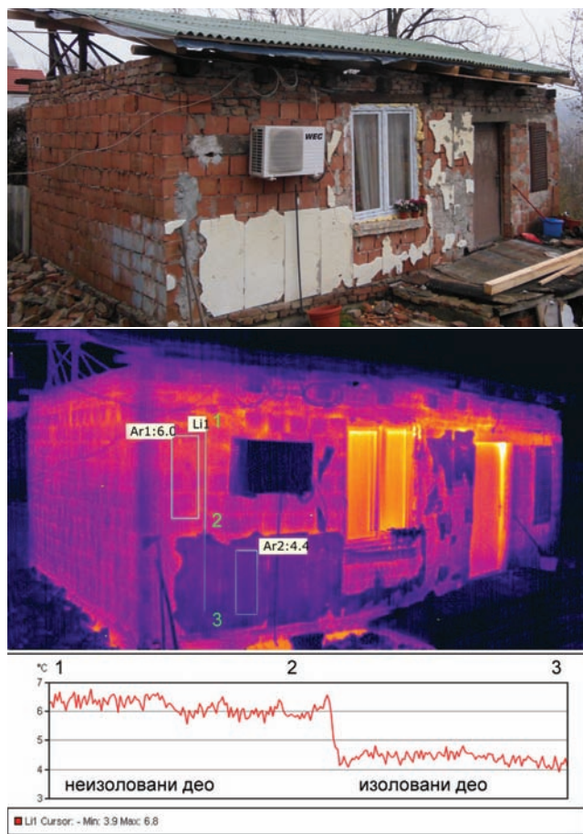
Слика 4. Пример 3: снимак фасаде, термограм и графикон температурног читавања. (Снимци ЈБ. Ђукановић и Д. Игњатовић)
