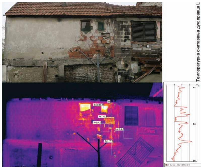
Слика 3. Пример 2: снимак фасаде, термограм и графикон температурног очитавања. (Снимци Љ. Ђукановић и Д. Игњатовић)
