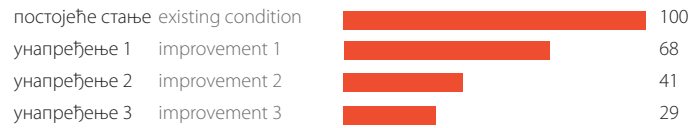
Графикон 5.12. Смањење примарне енергије кроз унапређења у односу на постојеће стање (грејање, припрема СТВ и осветљење) [%]
