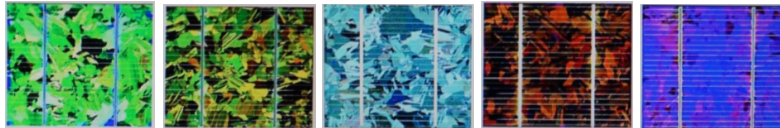
Slika 6. Zelena (efik.11.8%), zlatna (12%), srebrna, smeđa (12.5%) i ljubičasta (13.2%) polikristalna ćelija sa specijalnim antirefektivnim premazom (izuzev srebrne).
