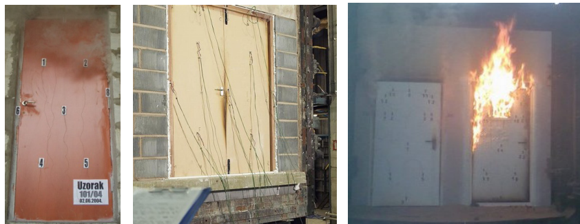
Slika 14. Ispitivanje vrata u laboratoriji IMS, Bgd i nekim drugim laboratorijama
