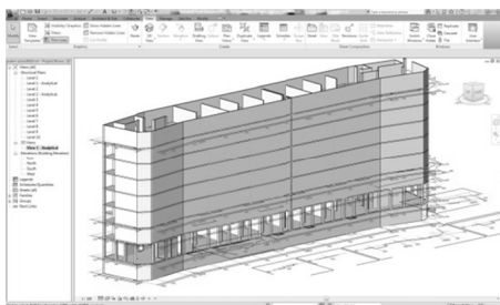
Slika 2. Unos geometrije modela u REVIT structure na osnovu 2-D AutoCAD crteža
