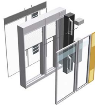
Slika 9 i 10. TeMotion Wicona, aktivna element fasada, posebno pogodna za modernizaciju visokih objekata visokih performansi, integriše više aktivnih sistema (www.wicona.de)
