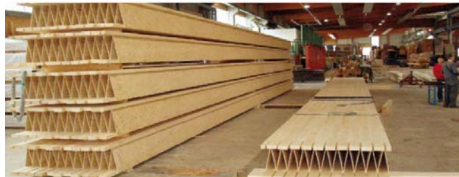
Slika3. Primer naboraste međuspratne tavanice tipa „Kielsteg“ [5]
