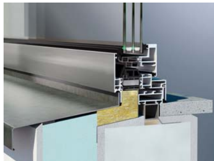
Slika 3. Schuco 90.SI+ Sistem, prozor pogodan za modernizaciju, nije potrebna demontaža postojećeg štoka, kao ni obrada unutrašnje špalete ( www.schuco.de ) Slika 4. Modernizacija fasada sa prozorskim trakama ( www.schuco.de )
