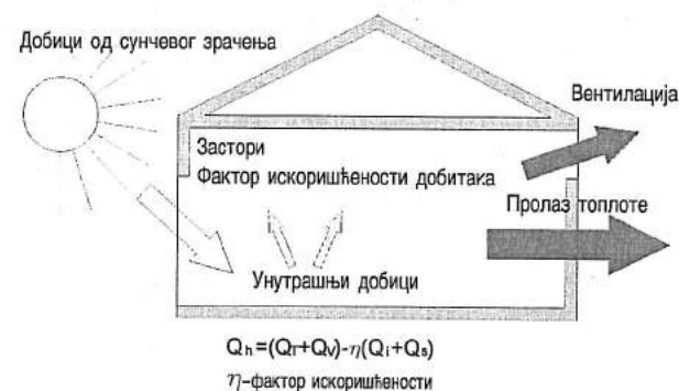
Слика 1. Илустрација методе прорачуна потребне количине енергије грејања нето површине објекта према европском стандарду EN 832
