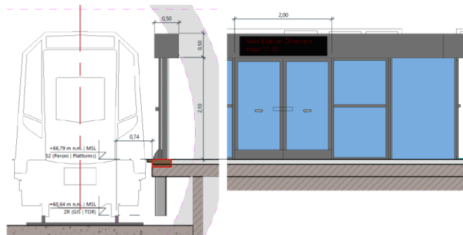
Slika 110. Platform Edge Doors System – osnovna šema
