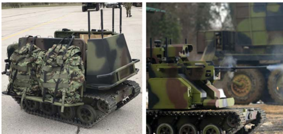
SLIKE 1-2 _ Logističko daljinski upravljano besposadno zemaljsko vozilo Miloš – L (levo); Daljinski upravljano besposadno zemaljsko vozilo Miloš (desno); (PPT NAMENSKA. Vojni program – Miloš. Daljinski upravljano besposadno zemaljsko vozilo. Preuzeto sa: https://pptnamenska.rs/milos/ )
