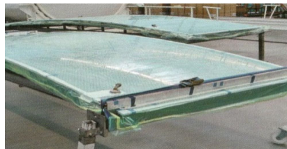
Slika 3. Proces hladnog savijanja stakla – na potkonstrukciji, u fabrici [5]
