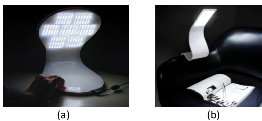
Slika 5. Stone lampe u koje su ugrađeni (a) LED i (b) OLED izvori svetlosti [10].
