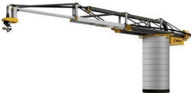
Слика 5. Приказ крана за 3Д штампање бетонских елемената / структура. Извор: Баниасади, 2021.
