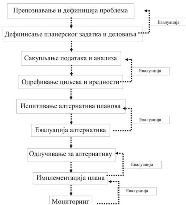
Дијаграм 12.: Модел планирања / пример алокације Трећег лондонског аеродрома, где се евалуација плана врши после сваке фазе. Извор: Commision on the Third London Airport: CTLA Report, HMSO, London, 1971. У Lichfield, N., Whitebread, M. & Kettle, P. (1975). Evaluation in the Planning Process. Oxford, Pergamon Press Ltd., Headington Hill Hall, стр 5.
