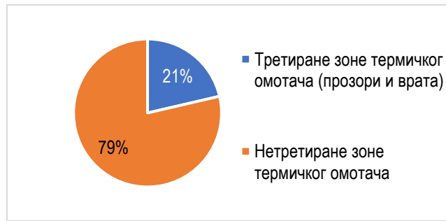
Графикон 13. Приказ заступљености третиране транспарентне зоне у склопу термичког омотача објекта 1,2/D (Илустрација аутора)
