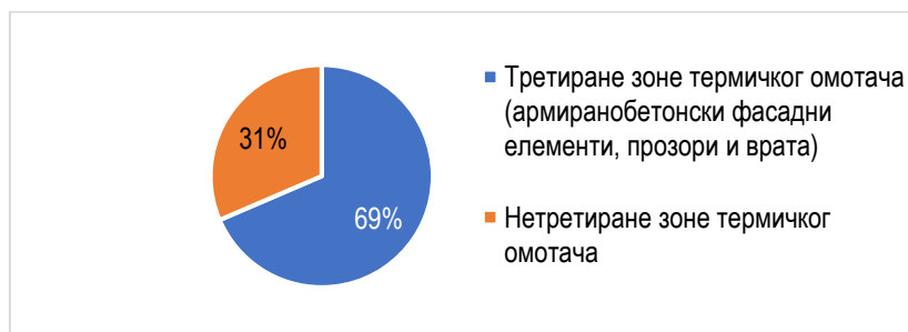
Графикон 5. Приказ заступљености површине анализираних (третираних) елемената у укупној површини термичког омотача сегмента зграде 28/1 (Илустрација аутора)
