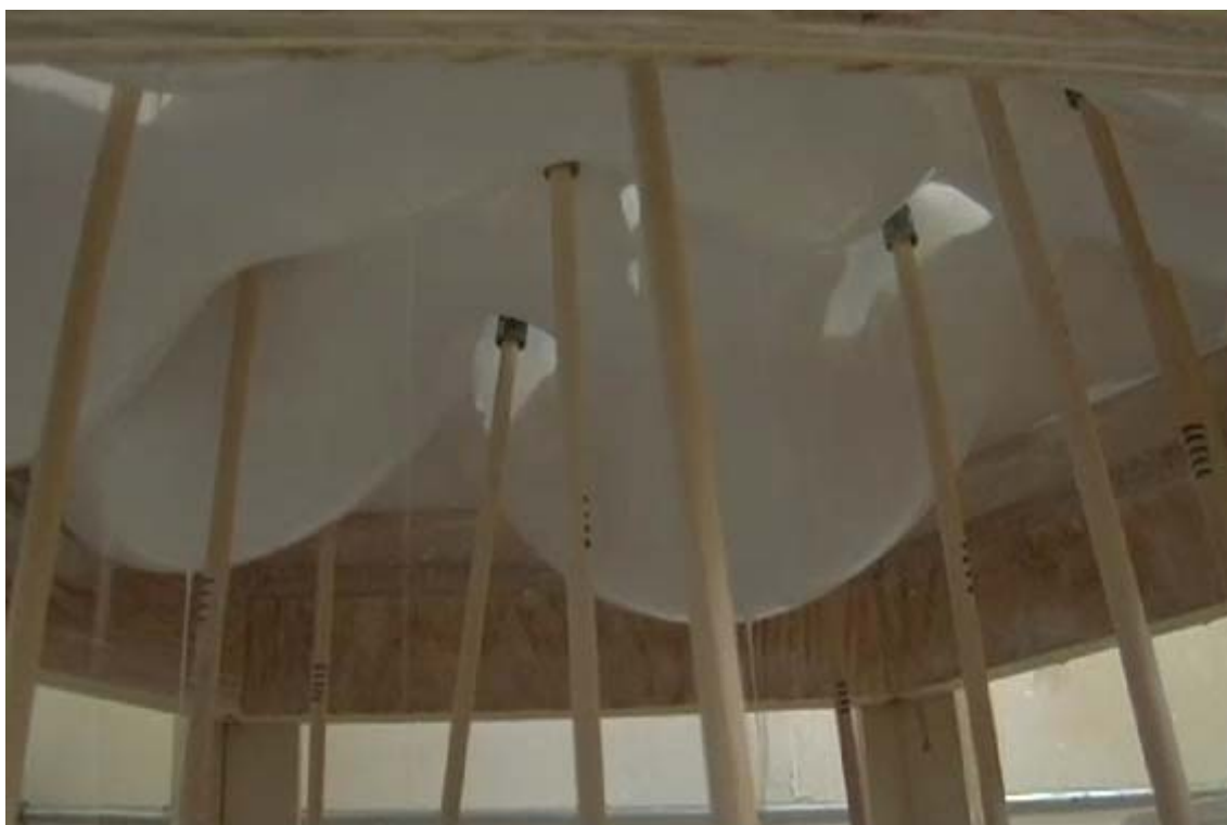
Слика 1.5.3.1 Механизам који контролише понашање два градивна материјала, платна и гипса. Прототипски модел „Wall P“, Andrew Kudless 2006-09. Кадар из филма у продукцији SFMoMA 2009. поводом изложбе „Sensate Bodies and Design“.
