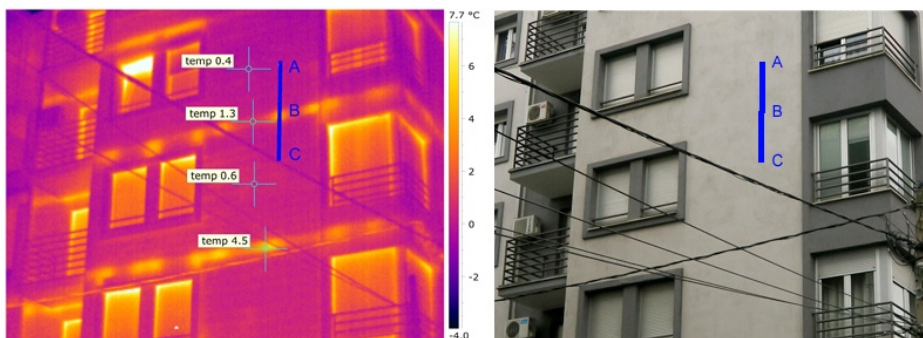
Слика IV-16 Карактеристичан детаљ удвојеног серклажа вишеслојог фасадног зида где се пројектом предвиђа постојање термоизолационог слоја, док је у пракси вероватно дошло до његовог изостављања и појаве знатно већих температурних читавања у односу на симулиране вредности (приказан је склоп ФСб)
