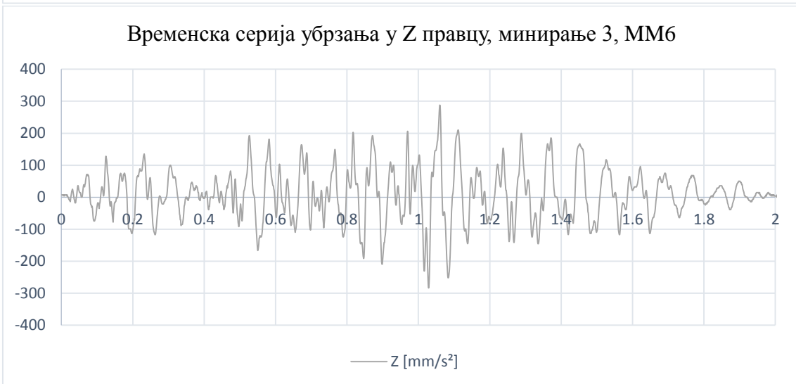
Слика 35: Временски запис убрзања серије минирања 3, на мерном месту 6 (ММ6)
