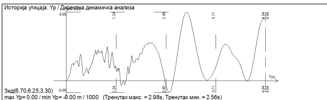
Слика 29: Анализа померања у зиду, који показује највећа померања у У правцу (подужни зид, који је пре доградње ветробрана био улазни фасадни зид)
