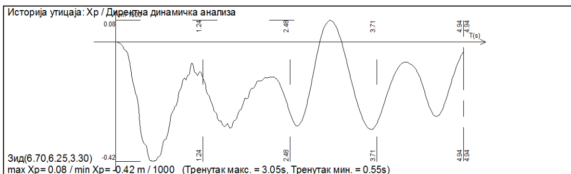
Слика 28: Анализа померања у зиду који показује највећа померања у Х правцу (средњи попречни зид)
