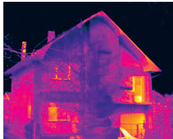
Породична кућа са масивним зидовима од опеке и фасадом накнадно изолованом у зони малтерисане фасадне обраде. Конструкција прозора и улазних врата је неодговарајућа са приметним топлотним губицима. Кућа се не греје у целости а услед добитака од сунчевог зрачења столарија на десној половини се очитава као топлија.
