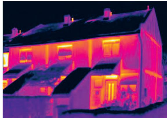
Породичне куће у низу са масивним зидовима од опеке и изолационим слојем у виду термоизолационог малтера. На термограму се уочавају изразити губици у зони армирано бетонских серклажа. Конструкција улазних врата и прозора је неодговарајућа са приметним топлотним губицима нарочито у зони кутије за ролетне. Поткровни простор се не греје.
