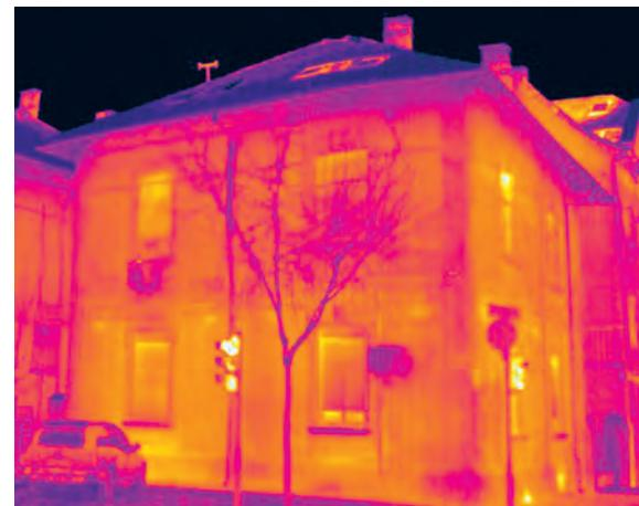
Стамбена зграда са изразито масивним, хомогеним, фасадним зидовима од опеке без термоизолације. Термограм приказује равномерне губитке топлоте кроз фасадне зидове који су изведени без армирано бетонских серклажа. Поткровни простор је накнадно усвојен и термички изолован. Конструкција прозора са приметним топлотним губицима.
